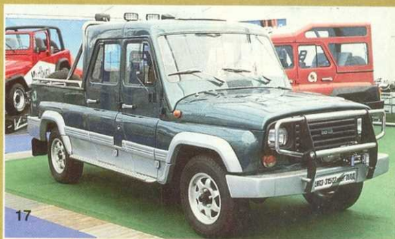
17. Московская фирма ЛЛД переоборудует обычные УАЗ-31512 в пикапы, универсалы с высокой крышей и другие модификации. Оснащенные передними защитными решетками, литыми колесами и различным дополнительным оборудованием, они имеют очень "заграничный" вид – как этот пикап со сдвоенной кабиной.
