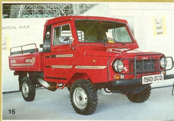
16. Практичный и очень нужный в селе пикап ЛуАЗ-13021 (описание см. ЗР, 1991, № 9) грузоподъемностью 400 кг. Как говорят, он "находится на пути к производству". Кстати, отечественные заводы показали на выставке немало пикапов, уже выпускаемых малыми сериями: "Бизон", "Бурлак" ГАЗ-2304, "Таврия-110550", "Москвич-2335"...
