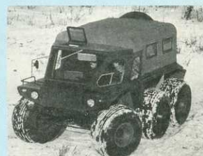
"Патруль-3М" на широкопрофильных шинах сверхнизкого давления.
