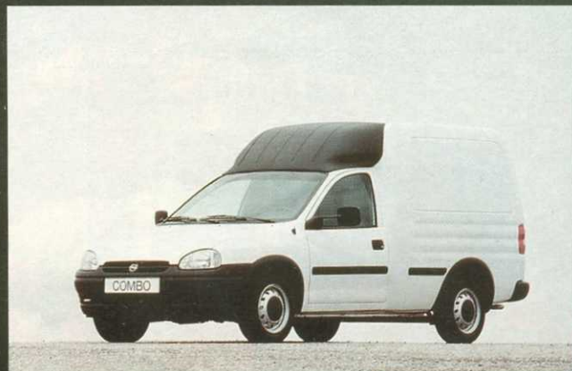
"Опель-Комбо". Фургон на базе легкового автомобиля особо малого класса "Опель-Корса". Полная масса — 1600 кг, грузоподъемность — 540–620 кг в зависимости от мощности двигателя: бензиновый (1388 см 3 ; 60 и 82 л. с.) и дизельный — 1686 см 3 , 60 л. с. Максимальная скорость — 142–160 км/ч.
