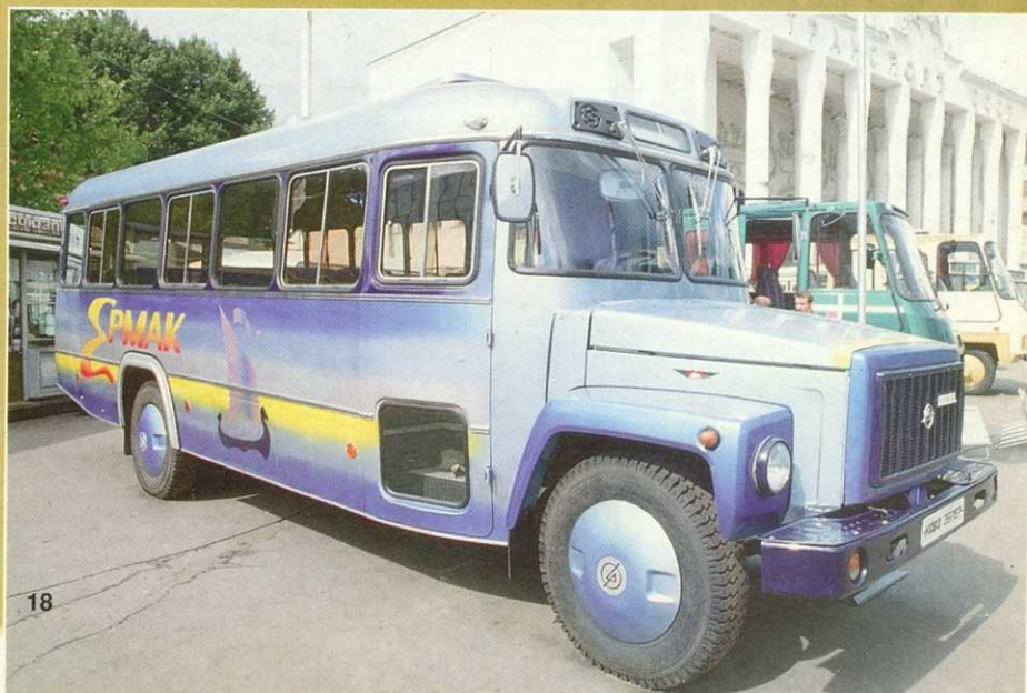
18. Длинный, как такса, 29-местный автобус КАвЗ-39767 со 138-сильным японским дизелем "Хино". База машины по сравнению с известным серийным автобусом КАвЗ-3976 увеличена на 780 мм. Естественно, радиус поворота вырос с 9 до 10,7 м.
