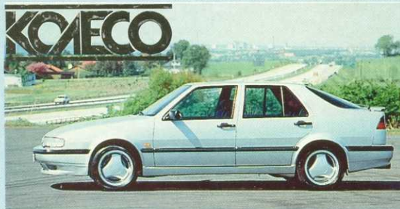
«СААБ-9000-Аэро» — одна из самых мощных и дорогих моделей с кузовом «хэтчбек». Двигатель — бензиновый с турбонаддувом, рабочий объем — 2290 см 3 , мощность — 200 л.с./147 кВт при 5500 об/мин. Максимальная скорость — 235 км/ч.
