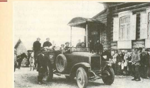
4. Первый советский грузовик АМО-Ф15 из первой десятки, участвовавший наряду с двумя другими машинами той же модели в испытательном пробеге Москва-Ленинград-Москва. Ноябрь-декабрь 1924 года.
