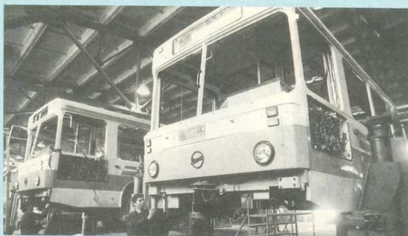
Сборка автобусов ЛиАЗ-5256 на заводе “Автотехтранс” в Ижевске. Фото ИТАР – ТАСС
