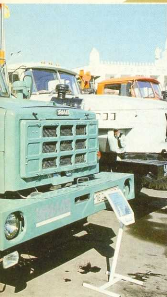
13. Полноприводный "Урал-44223" с новым оперением – свидетельство постоянной эволюции базовой модели Уральского автомобильного завода в Миассе. Этот седельный тягач оборудован 234-сильным дизелем воздушного охлаждения (лицензия КХД), который, наконец-то, начал малопомалу выпускать завод КДЗ в Кустанае.
